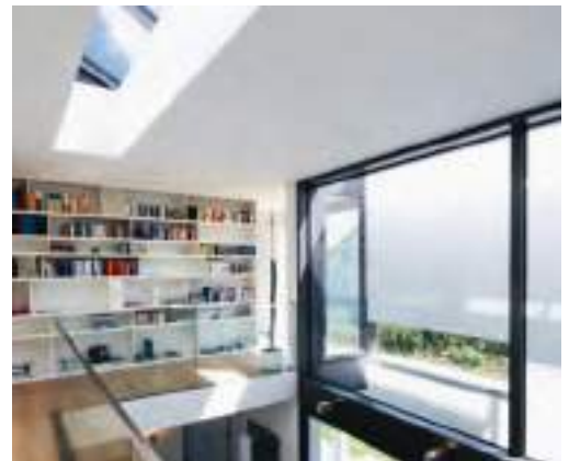
Käytännöllistä: Vaikeassa paikassa sijaitsevia ikkunoita voi ohjata Schüco TipTronicin, sähköisen piilohelan avulla.
